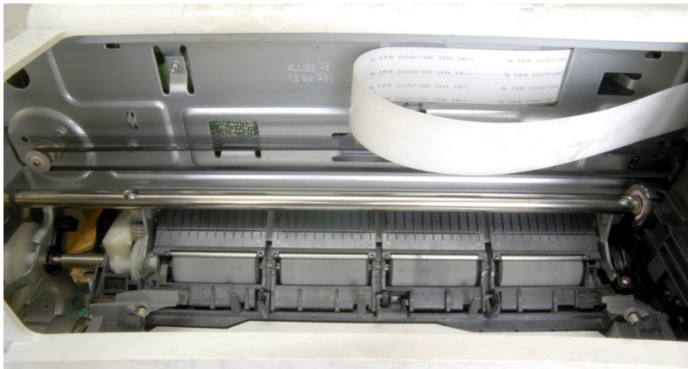
Rys. 5.3. Przykład przekładni ściągowej; zamiana ruchu obrotowego na posuwisto zwrotny o dużym skoku
